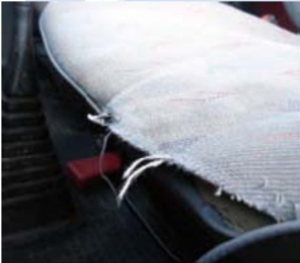
Scheuren en krassen in de bekleding
